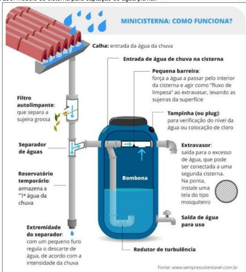
Figura 196: Modelo de cisterna para captação de água pluvial.
